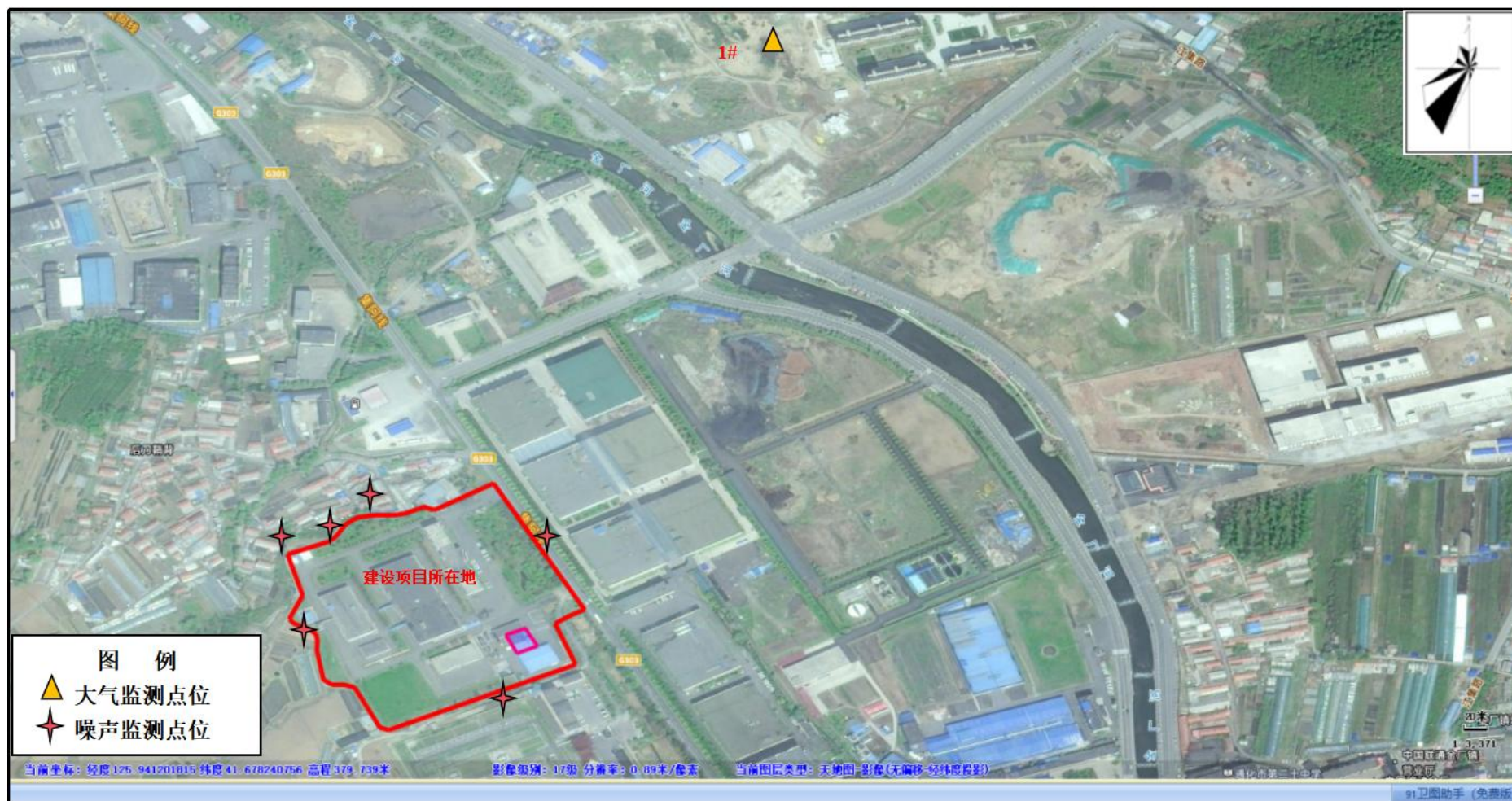
附图3 建设项目大气、噪声监测点位示意图
